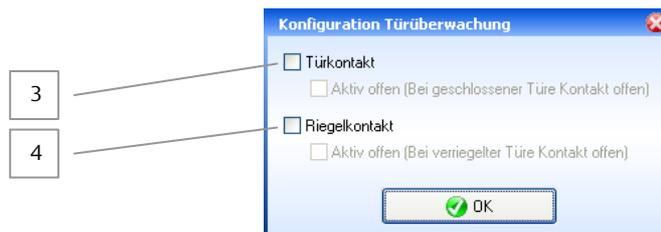
3. **Türkontakt (Door):** Befindet sich die Tür im geschlossenen oder offenen Zustand? Durch die zusätzliche Aktivierung des Feldes «Aktiv offen (Bei geschlossener Tür Kontakt offen)» wird der Kontakt umgekehrt ausgewertet. Je nach Reedkontakt muss dieser Status geändert werden (Öffner oder Schliesser).
